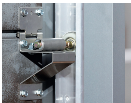
Robuste, kugelgelagerte Laufrollen sorgen für eine maximale Laufruhe
